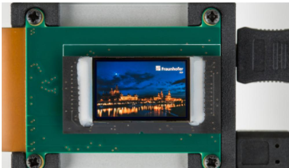
Dank eines ausgeklügelten Systemkonzepts und moderner Designmethodik erzielt das neue OLED-Mikrodisplay eine Auflösung von 1920 x 1200 Pixel. © Claudia Jacquemin | Bild in Farbe und Druckqualität: [www.fraunhofer.de/presse](http://www.fraunhofer.de/presse).
